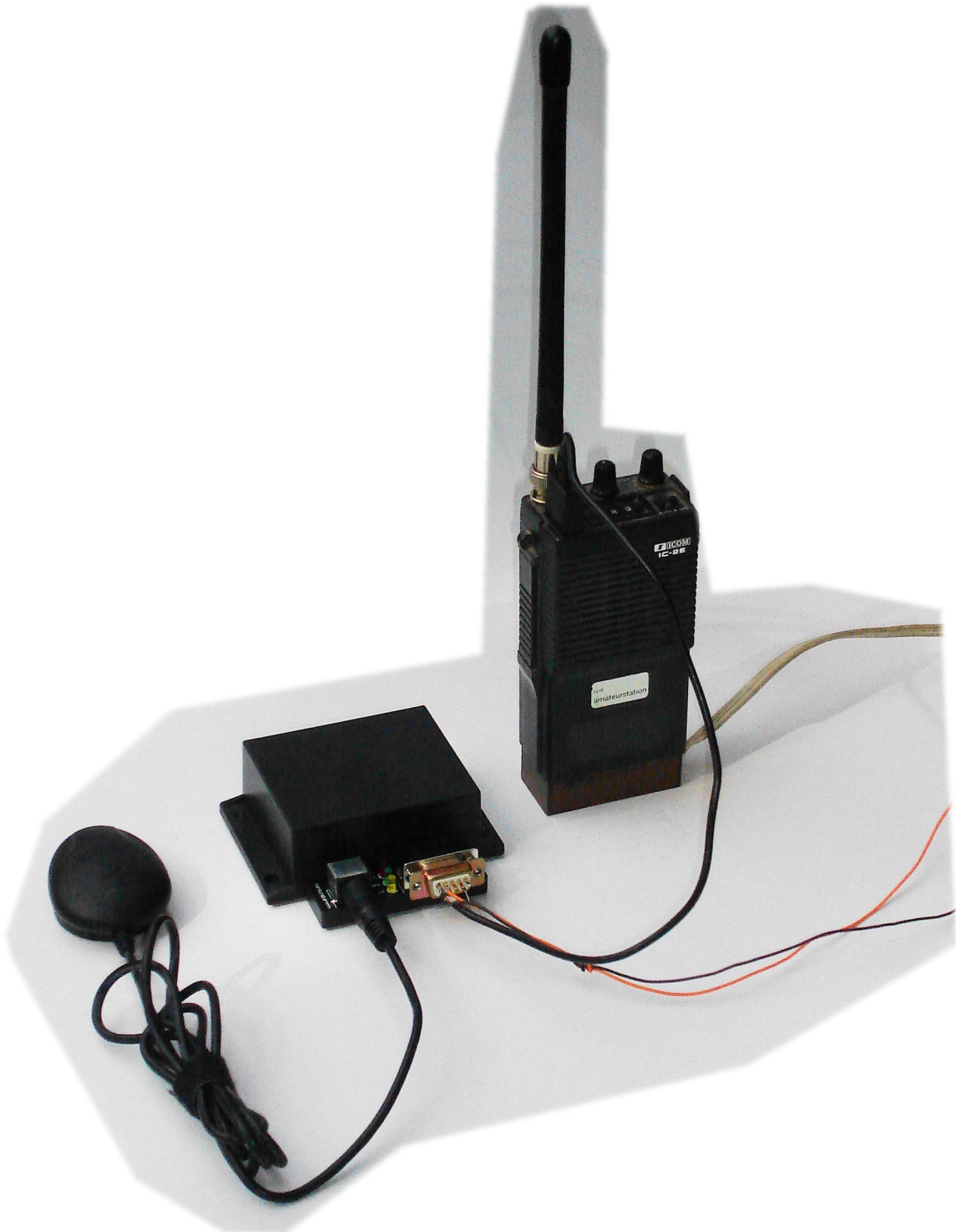
Proefopstelling met Navilock NL-303P GPS muis en oude IC2e.
